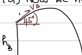
$$t^2 - \frac{2V_0}{g} \sin 45^\circ t - \frac{2h_B}{g} = 0$$
